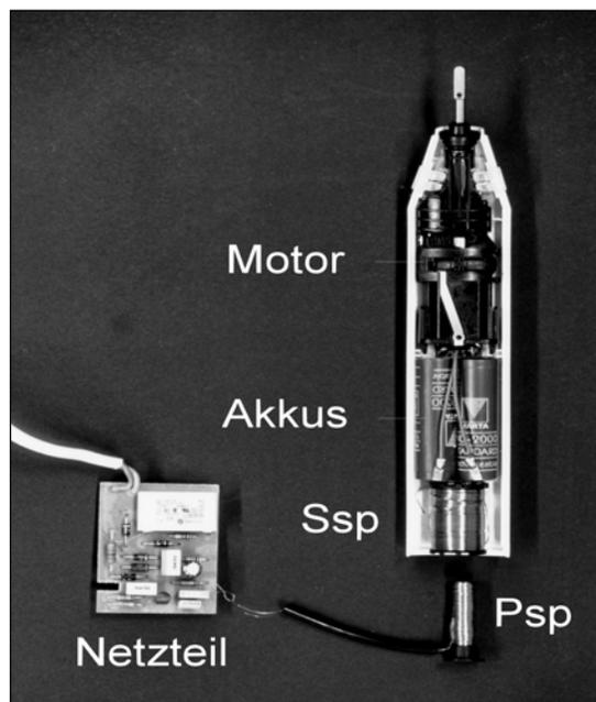
Abb. 2: Innenansicht mit Netzteil (links) und eigentlicher Zahnbürste (rechts); Psp = Primärspule; Ssp = Sekundärspule
