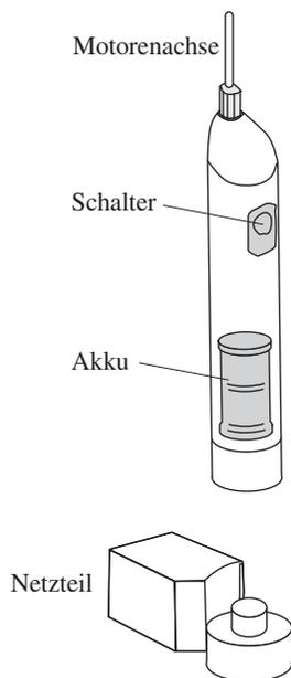
Abb. 1: Schema einer elektrischen Zahnbürste
