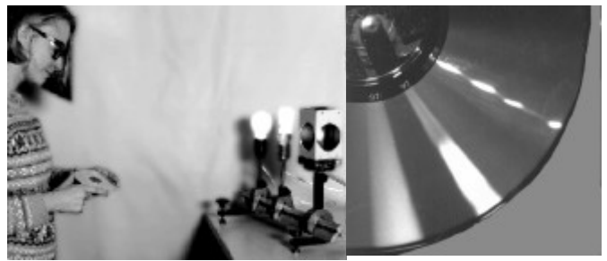
Mit Hilfe einer CD werden die Spektren verschiedener Lichtquellen betrachtet.
